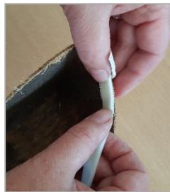
3/ Coller les mousses en les faisant dépasser de 2 mm du bord
